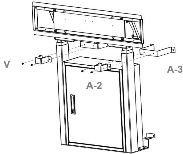
Verschrauben Sie die beiden weiteren Elemente der Boden-Wand Halterung.
