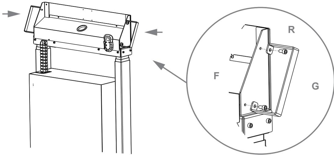
Verschrauben Sie die Griffe an der Seite des Lift-Systems | Screw the handles to the side of the lift system.
