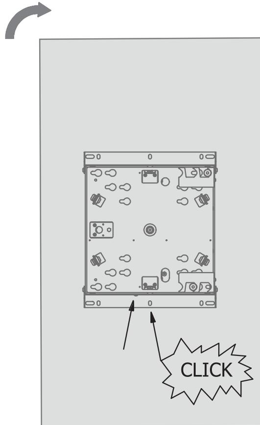
Probieren Sie die Drehung mehrmals aus und vergewissern Sie sich, dass der Bildschirm mit den Sicherungsbügeln sicher verriegelt ist. Erhöhen oder verringern Sie bei Bedarf die Federkraft durch Verstellen der Schraube.
