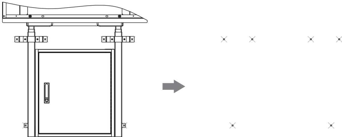
Stellen Sie das System an die gewünschte Wand, markieren Sie die Löcher für die Bohrungen und platzieren Sie die Bohrungen.
