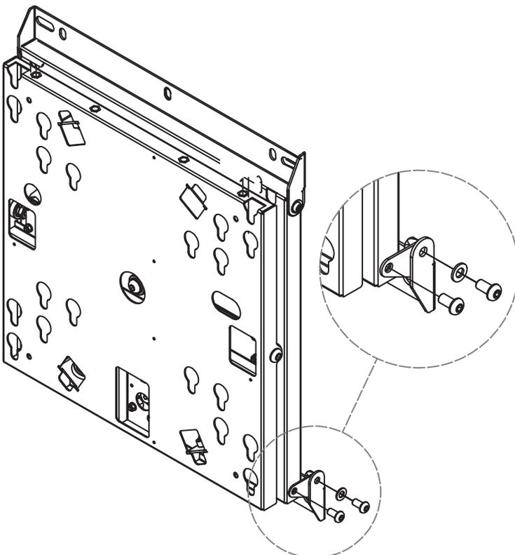
Entfernen Sie die Schrauben und die Unterlegscheiben.
