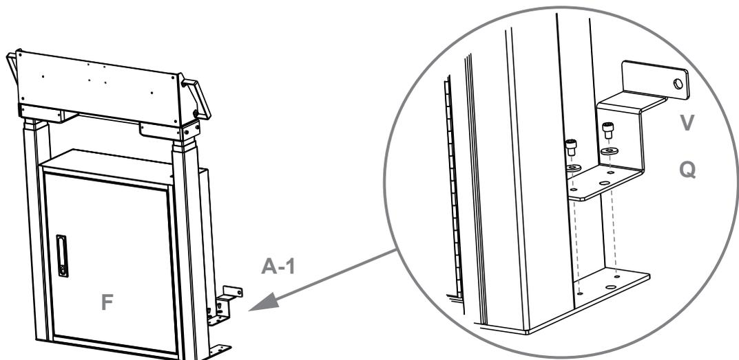
Verschrauben Sie das Liftsystem mit dem ersten Element der Boden-Wand Halterung.
