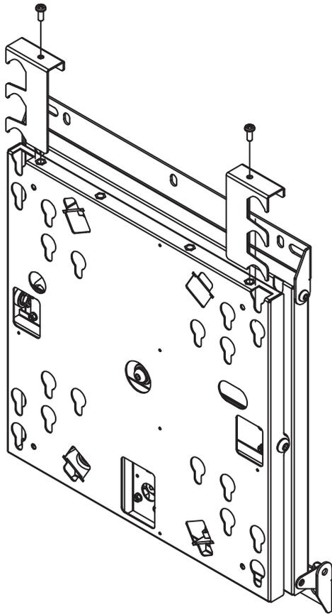
Entfernen Sie den Sicherheitsbügel.
